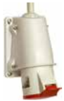
PKF16W434 4x16A duvar prizi, IP44 vidalı bağlantı
